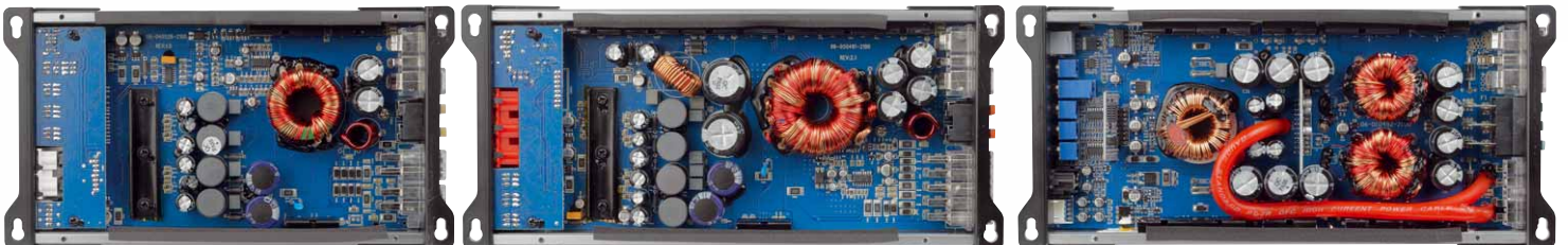
Die Sinuslive sind sauber aufgebaut und ordentlich bestückt. Alle Kanäle der SL-A4100D (links), SL-A8005D (Mitte) und SL-A1000D sind Class-D-Typen
